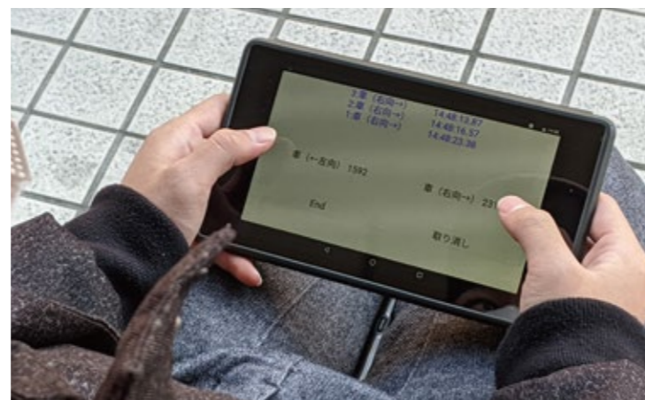
図 6-2 自動車交通量の目視調査の様子(タブレット用アプリをこの調査のために作成した。)
